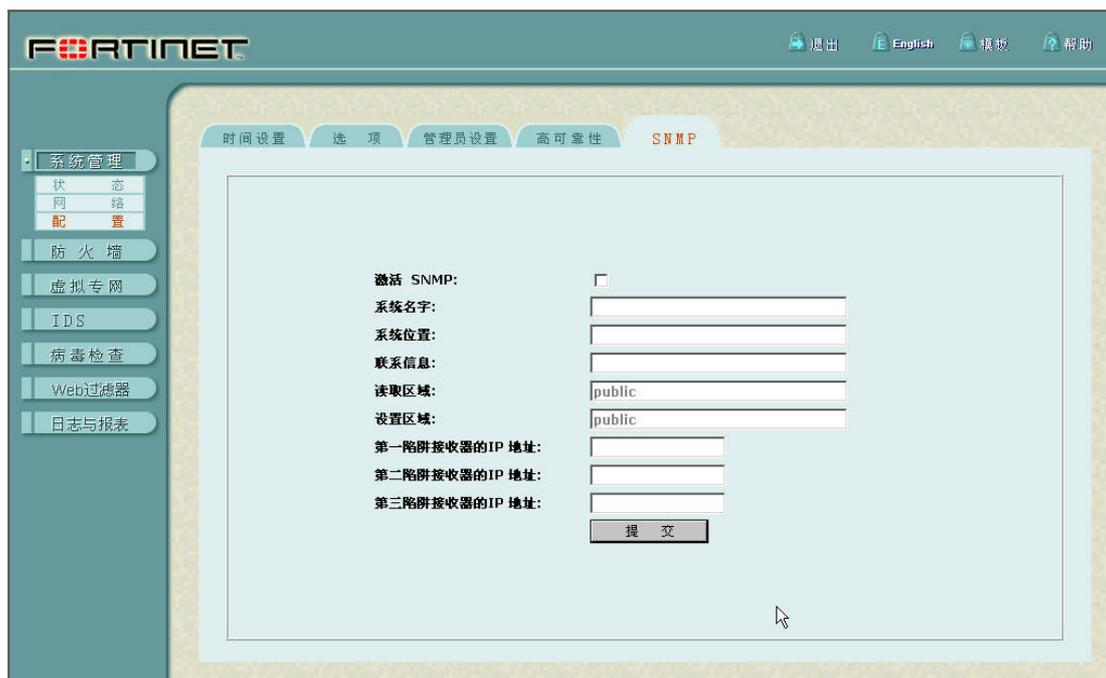
SNMP 的协议设置可以激活 SNMP 的响应，并且可以自定义几个最常见的 SNMP 的属性。
