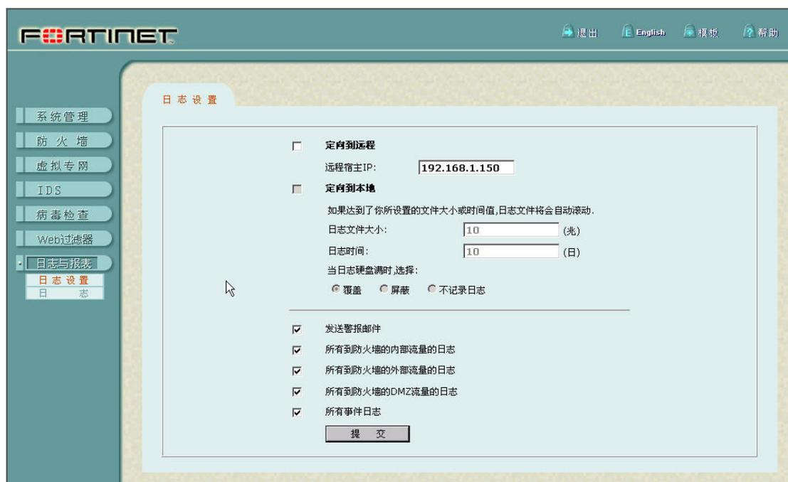
最后一个就是防火墙的日志处理了,简单的可以用 SYSLOG 的格式重定向到另外一个 SYSLOG 的服务器上处理,也可以保存在本地的 FLASH 盘上处理。
